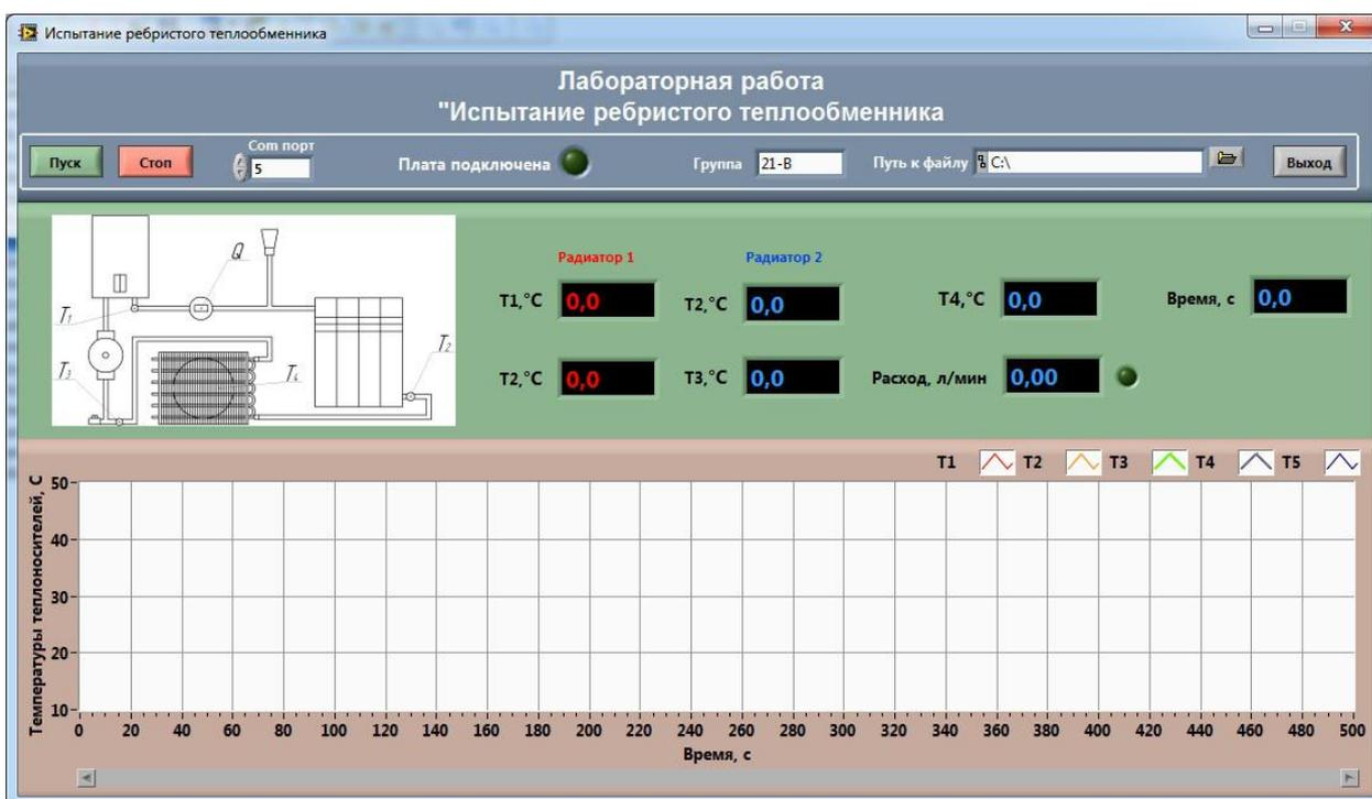
рис. 3 – Лицевая панель компьютерной системы измерения
