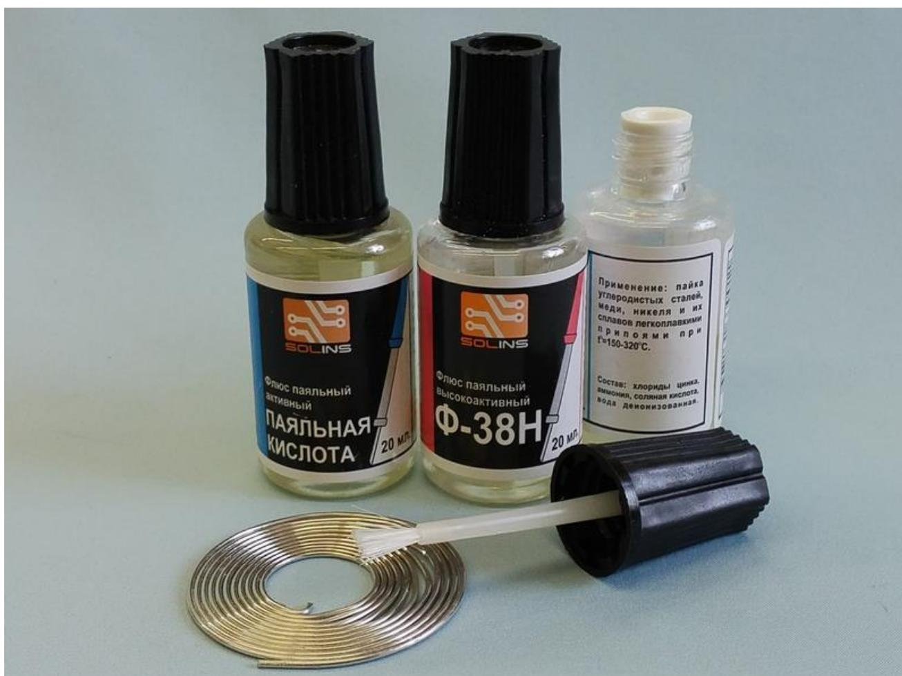
Химически активный флюс содержит кислотные компоненты. Последние предназначены для уничтожения налета окислов либо следов коррозии. Таковыми химикатами может быть соляная кислота, дихлорид цинка, называемый паяльной кислотой.
