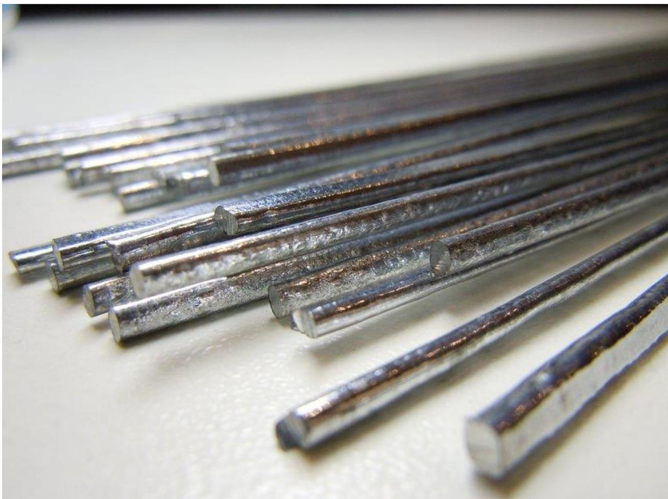
Припоем называется металлический стержень, который при плавлении заполняет свободное пространство между соединяемыми деталями. Пруток плавится, смешиваясь с сочленяемыми элементами, либо выступает в виде основного металла.
