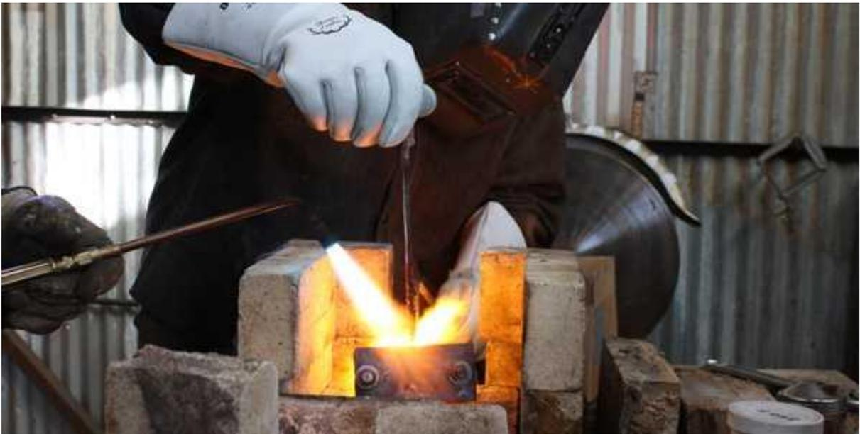
Проволока для соединения чугунных конструкций оговаривается стандартом 267180, и бывает двух марок — А и Б. Первая применяется при горячем методе сварки, который отличается общим нагревом обеих деталей.
