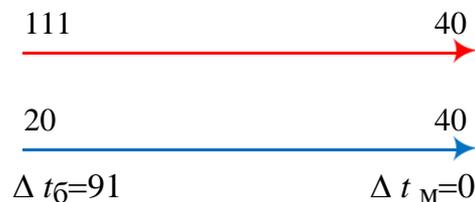
Делаем вывод, что, так как движущая сила процесса на одном из концов аппарата равна нулю, то **организация прямотока невозможна**.
