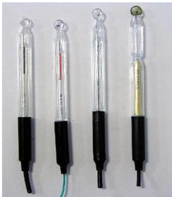
Рис. 2.5 Стекланный электрод для измерения рН: 1 — стеклянная рН-чувствительная мембрана; 2 — 0,1 М раствор HCl, насыщенный AgCl; 3 — серебряная проволочка; 4 — стеклянная трубка; 5 — изоляция; 6 — токоотвод
