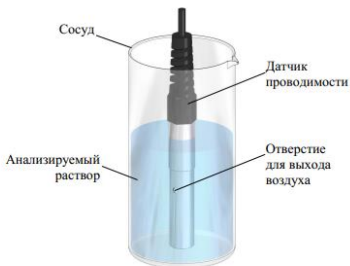
Рисунок 2.3 – Проведение измерений погружным методом
