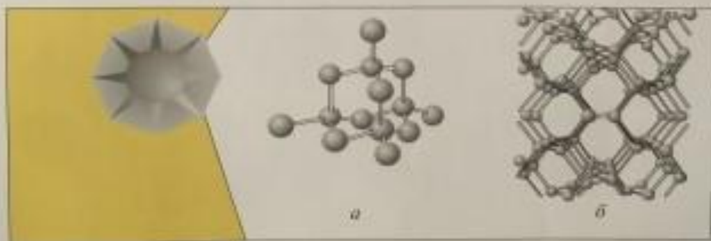
Рис. 3. Модель атомной кристаллической решетки алмаза: а — фрагмент из элементарных тетраэдров; б — бесконечный кристалл
