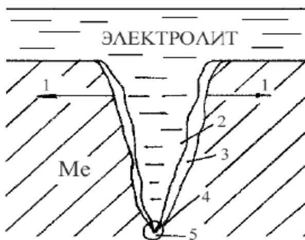
Рис. 2.5 Схема коррозионной трещины: 1 – направления растягивающих напряжений;
